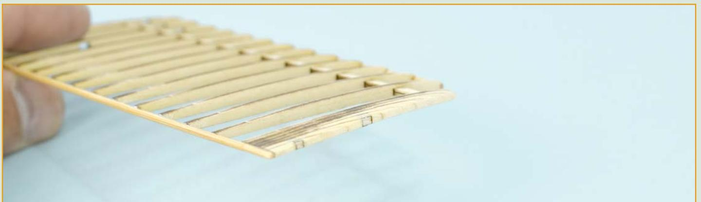
**9** Ориентируясь по снимкам, тщательно обработайте детали так, чтобы полностью убрать уступы и придать законцовкам равномерно гладкую и заостренную форму.
